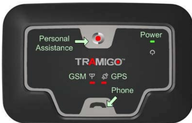
Figura 1 - Controles da Unidade T22
