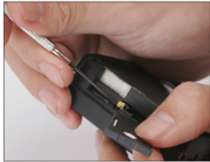
Sacando el sostenedor de la tarjeta SIM.
